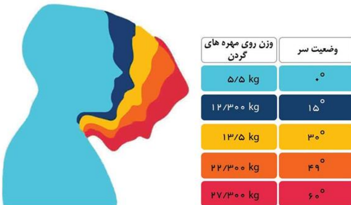
شکل ۹ میزان نیروی وارد بر مهره ها و مصلات گردن در موقعیت های مختلف
