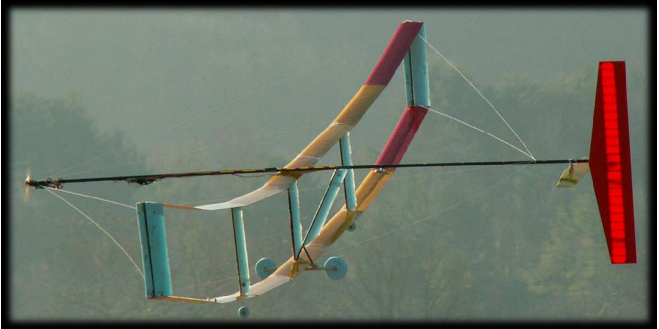
مدل یک چهارم ساخته شده ی بدون سرنشین برای تست آیرودینامیک و پایداری
