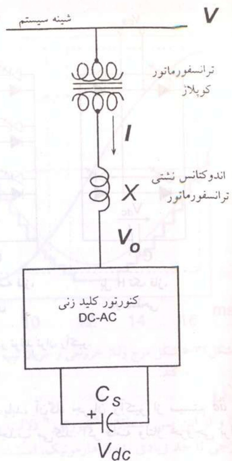
شکل ۵-۲۹ تولید توان راکتیو بوسیله چرخش در کلیدزنی کنورتور منبع ولتاژی.
