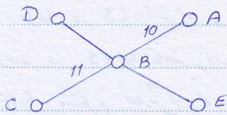
\* router A یک پیغام به B می‌فرستد که در فیلد IP Address آن آدرس C آذاشه و پیغام از نوع تقاضا است یعنی می‌گوید router B به من بگو هزینه ات تا C چقدر است؟ B وقتش می‌خواهد پاسخ می‌گوید router A، هزینه من تا C، 11 است ...!!!
