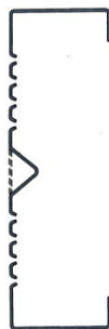
شکل ۴-۲- طولانی کردن مسیر جریان حرارت با ایجاد خم‌های متعدد در جریان پروفیل
