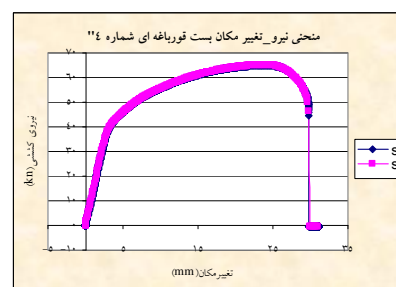
شکل ۷- منحنی نیرو-تغییر مکان بست قورباغه‌ای شماره ۴
