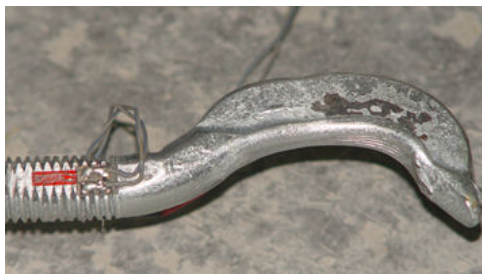
شکل ۸- باز شدن قلاب در بست‌های قورباغه‌ای تحت نیروی کششی
