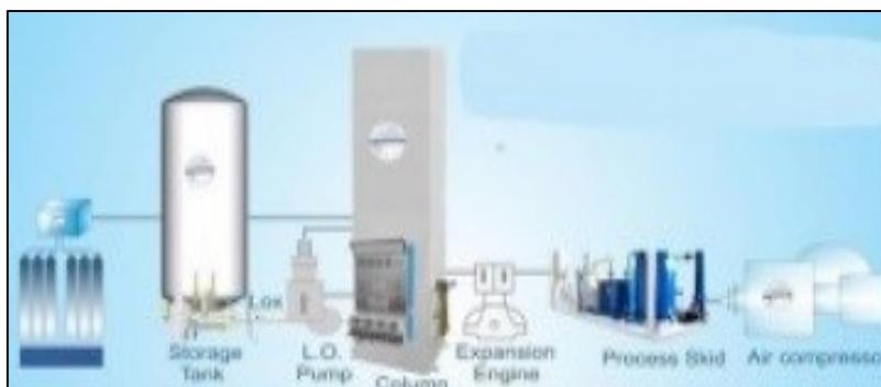
شکل ۲۵- تولید اکسیژن به روش تقطیر جزء به جزء توسط سپرتور هوا
