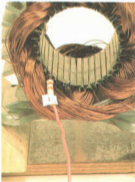
شکل ۳-۱۱- اتصال سیم افشان به اهرم و اتصالی فلز و برجسته زدن آن
