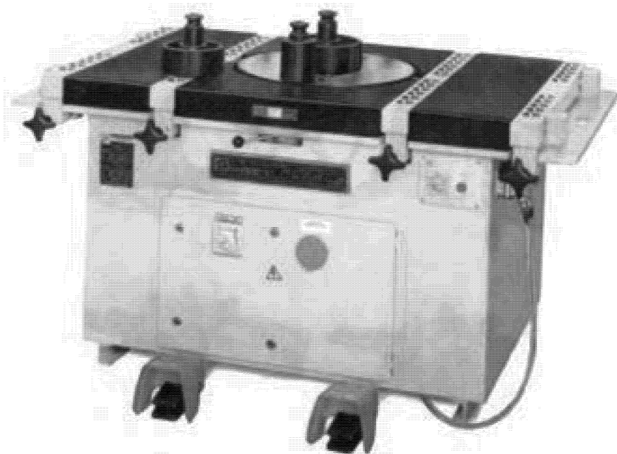
شکل ۲-۶۳ - دستگاه میل گرد خم کن برقی
