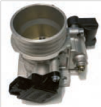
شکل ۲۹- مجموعه کامل دریچه گاز
