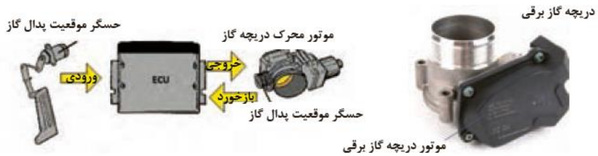
شکل ۳۱- دریچه گاز برقی و سیستم کنترل آن
