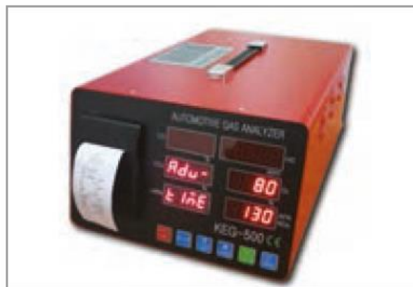
شکل ۸- نمونه آنالیزور پنج گاز
