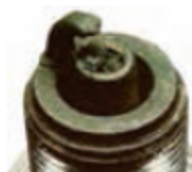
شکل ۳- آسیب به شمع بر اثر خودسوزی
