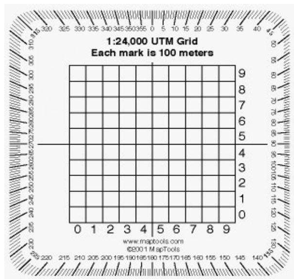
همانطور که مشاهده می کنید این ابزار برای یک نقشه ۱:۲۴۰۰۰ می باشد . به یاد داشته باشید که برای مشخص کردن موقعیت دقیق ، باید لبه های این ابزار بر روی لبه های دو خط شبکه که فاصله آنها یک کیلومتر است منطبق باشند ( مطابق شکل زیر )
