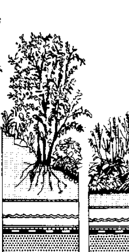
ارتفاع ریشه < 250 cm ارتفاع موثر از 35 cm fm بار سطح 3.7 kN/m 2 تجهیزات آبی 170 l/m 2 پوشش مانع cm مخروط خاک 23 cm لایه زهکشی 12 cm اندازهٔ دشت یا تومانتک
