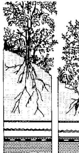
ارتفاع ریشه < 250 cm ارتفاع موثر از 35 cm fm بار سطح 3.7 kN/m 2 تجهیزات آبی 170 l/m 2 پوشش مانع cm مخروط خاک 23 cm لایه زهکشی 12 cm اندازهٔ دشت یا تومانتک
