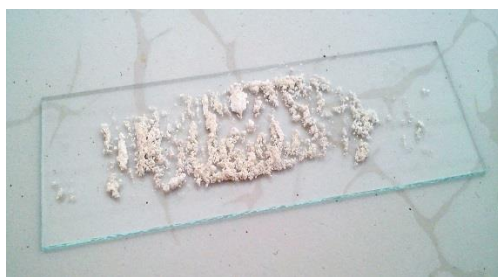
تصویر ۲: پودر شیشه روی سطح زیر لایه (شیشه لامه) درون کوره قرار داده می‌شود.
