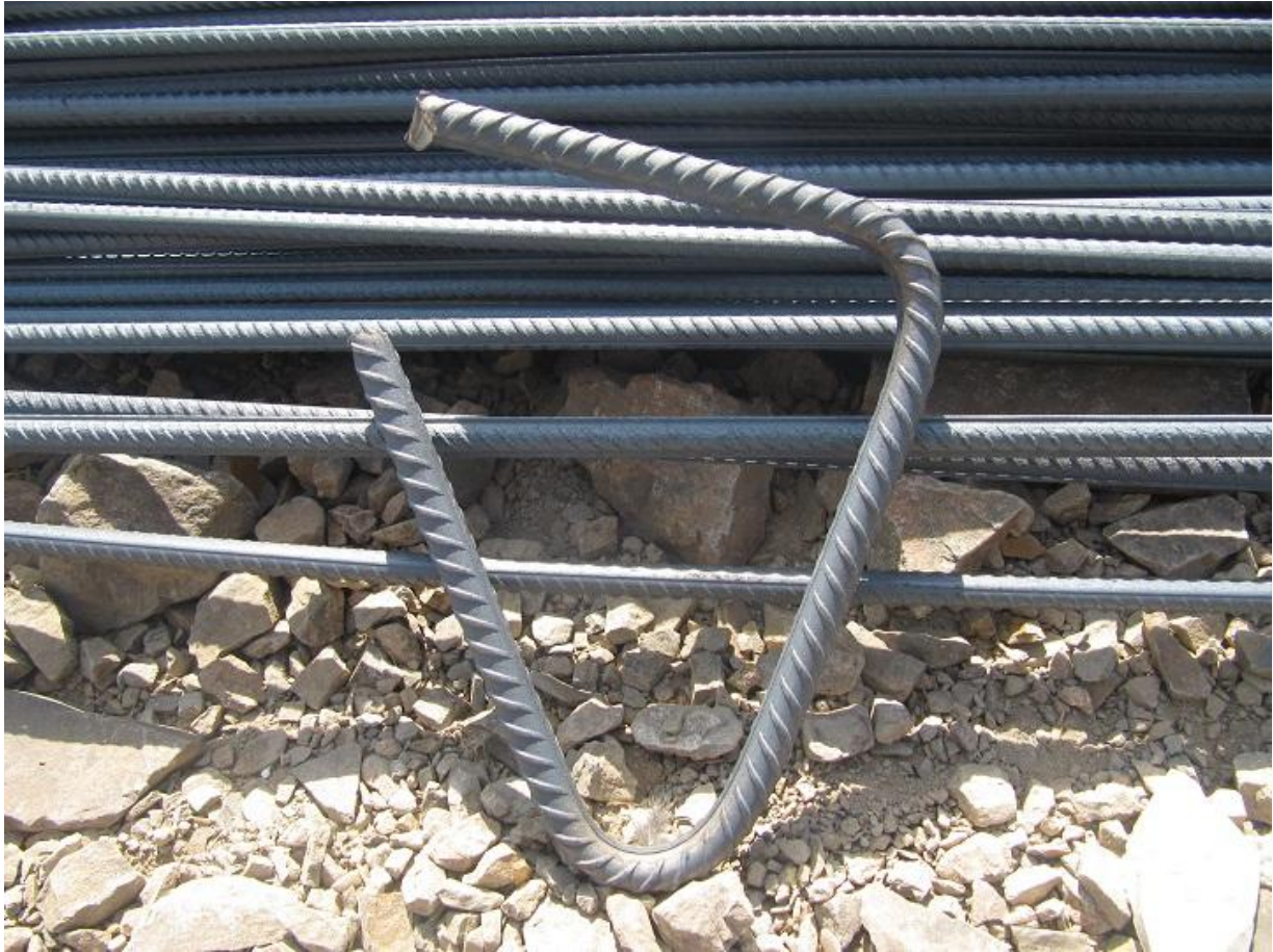
شکل ۳۲-میلگرد با زوایای نود و صد و سی و پنج(چهل و پنج) درجه
