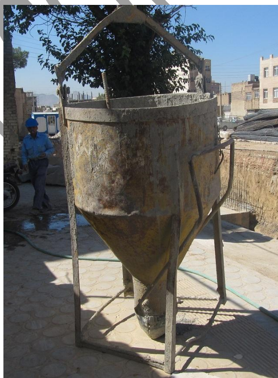
شکل ۲۴- باکت بتن ریزی
