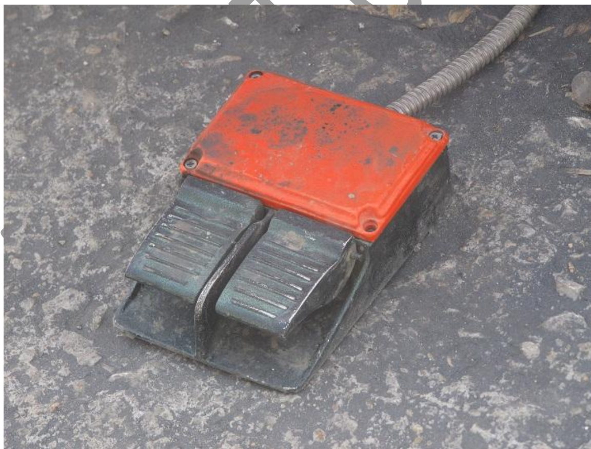
شکل ۳۱- پدال موجود در دستگاه خم کن میلگرد جهت درست کردن میلگرد های ۹۰ و ۱۳۵ درجه
