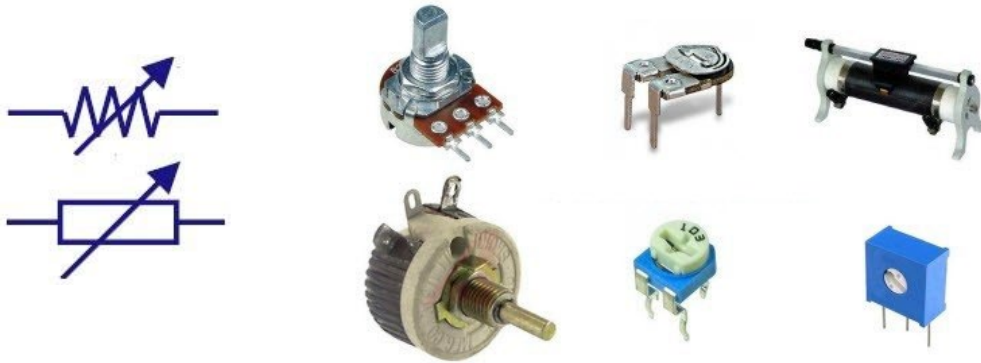
شکل (۲): انواع مقاومت های متغیر و نماد مداری آن
