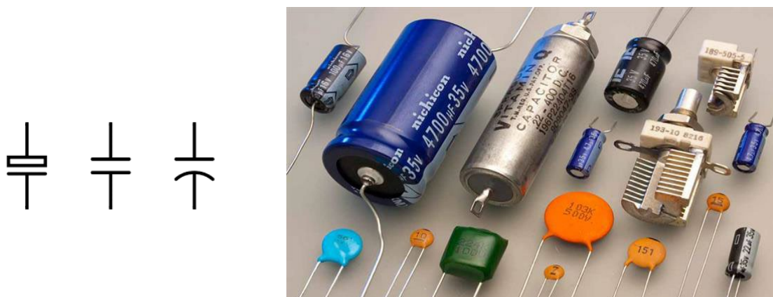
شکل (۶): خازن و نماد مداری آن
