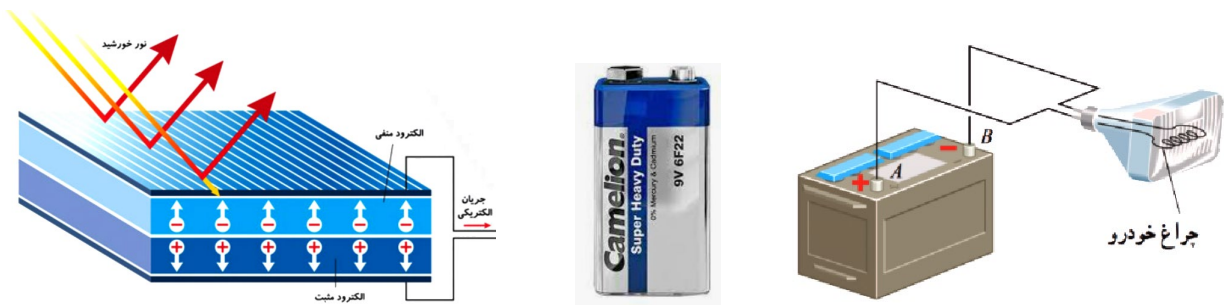
شکل (۱): چند نمونه منبع ولتاژ - باتری خودرو - باتری ۹ ولت و سلول خورشیدی
