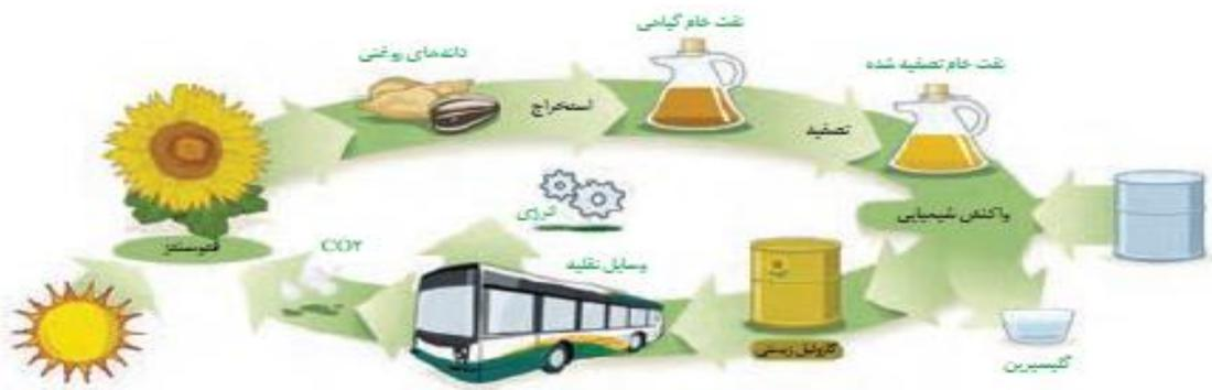
شکل شفرایند چرخه‌ای تولید گازوئیل ریستی از دانه‌های روغنی، مانند آفتاب‌گردان، زیتون یا سویا را به علت چرخه‌ای بودن این فرایند، تجدیدپذیر می‌داند. گازوئیل ریستی مواد سرطان‌زا ندارد و باعث بران ایمنی نمی‌شود.
