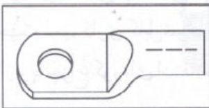
شکل ۱۹-۵- انواع کابلشو یا سرسیم
