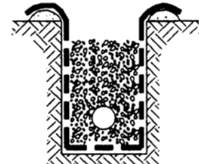
۴- ریختن مصالح زهکشی و تراکم
