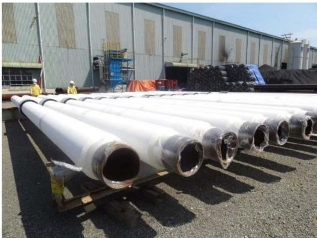
شکل ۱۶.۴. پوشش چندلایه پلی‌پروپیلن برای استفاده در عمق دریا [۳۱]
