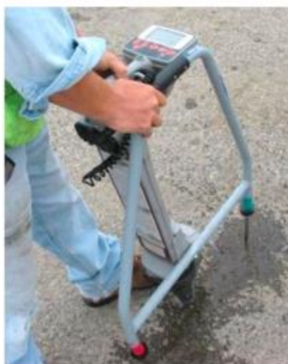
شکل ۳۱.۴. تصویر به‌کارگیری عصای دو پایه در روش ACVG [۵۱-۵۰]
