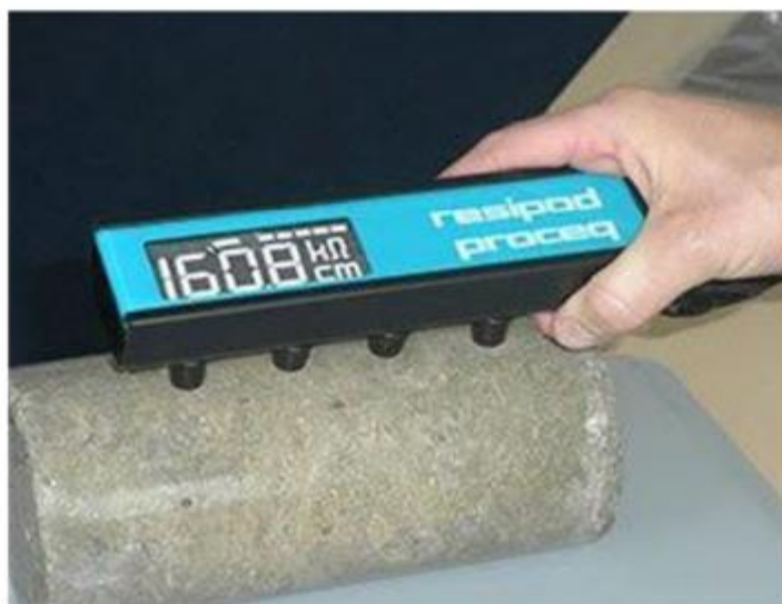
شکل ۲۴.۵. تصویر اندازه‌گیری مقاومت الکتریکی بتن به روش چهار پینه [۵۲]
