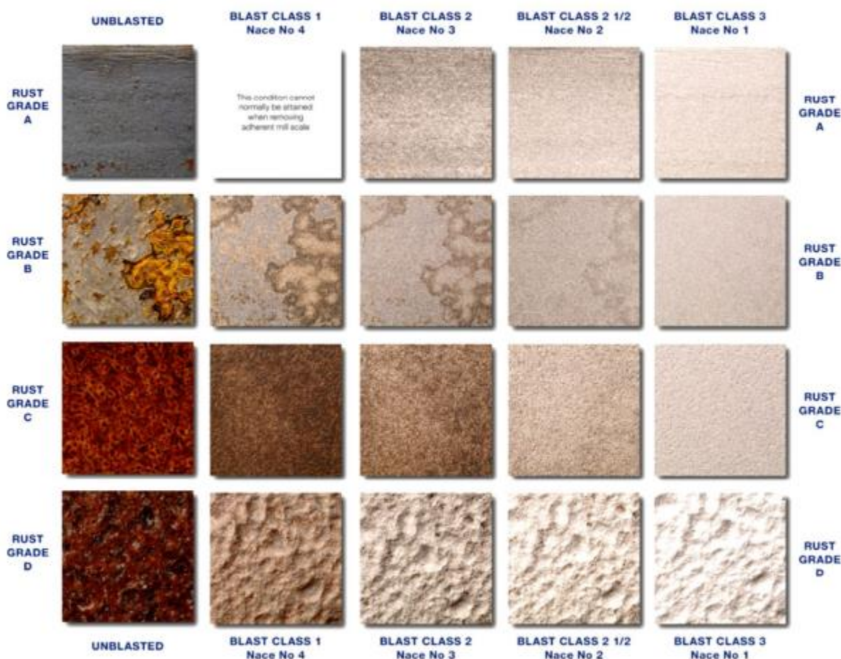
شکل ۲.۴. تصاویر درجه تمیزکاری برحسب درجه زنگ زدگی [۸]
