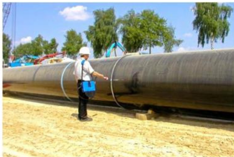
شکل ۲۶.۴. تصویر اندازه‌گیری محل عیب پوشش به روش هالیدی [۴۳]
