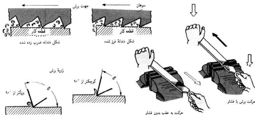
شکل ۱-۲۸ روش سوهان کاری
