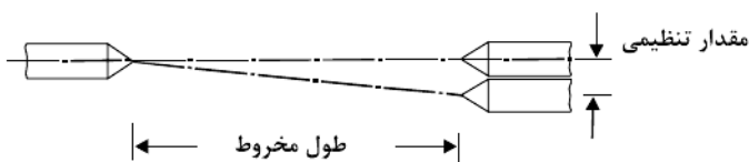
شکل ۳۴- روش مخروط تراشی با انحراف مرغک
