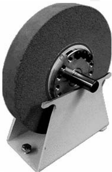
شکل ۷-۷ بالانس کردن سنگ
