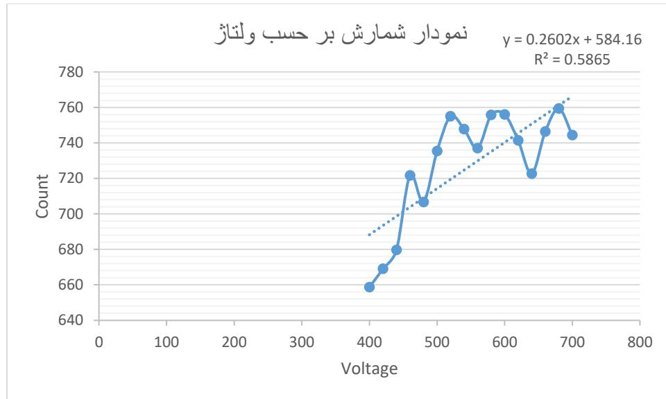
ولتاژ کار تقریباً برابر است با ۵۵۰ ولت
