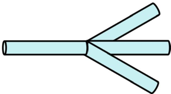
در حل مسائل لوله ها معادلات حاکم باید توامان حل شوند. تحلیل سیستم شبکه های آبرسانی که آب را در یک شهر توزیع می کنند پیچیده است. در اغلب موارد عملی نسبت طول لوله به قطر آن بزرگ بوده و می توان از افتهای موضعی صرفنظر کرد. جهت حذف افتهای موضعی رابطه تجربی  $\frac{L}{D} > 2000$  پیشنهاد شده است.
