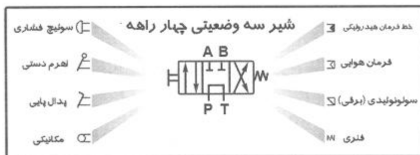
شکل ۴-۱ مکانیزمهای تحریک شیرهای کنترل جهت
