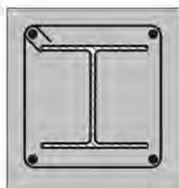
شکل ۲-۳-۵-۳- استفاده از روکش بتنی برای مقاومسازی ستون فولادی
