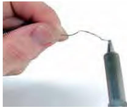
شکل ۴۳- اضافه کردن لحیم به نوک هویه
