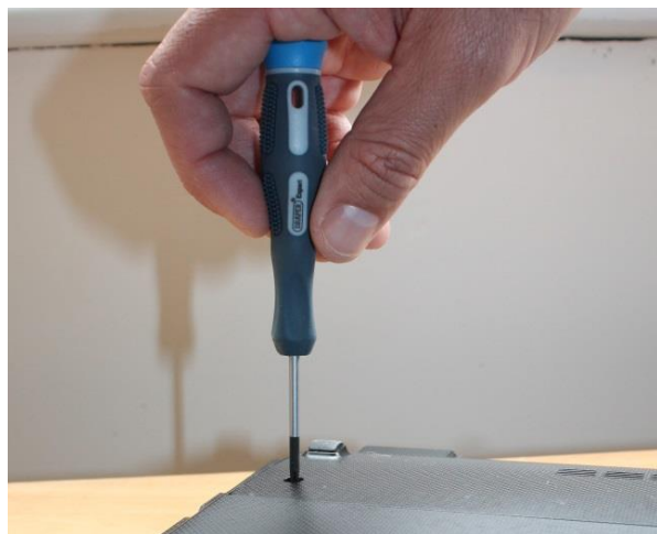
شکل ۳۱-۱ چگونگی صحیح در دست گرفتن پیچ گوشتی
