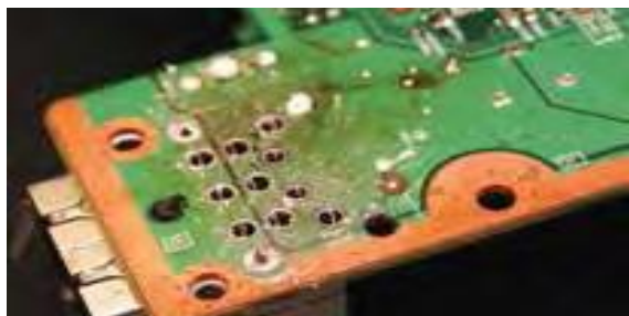
ب-برداشتن لحیم‌ها و آزاد کردن پایه‌ها
