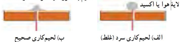
شکل ۵۰-۱-۵۰-۱ لحیم کاری صحیح و غلط
