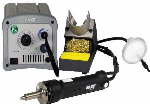
شکل ۸۸-۱ قلع کش حرارتی با پمپ مکش برقی
