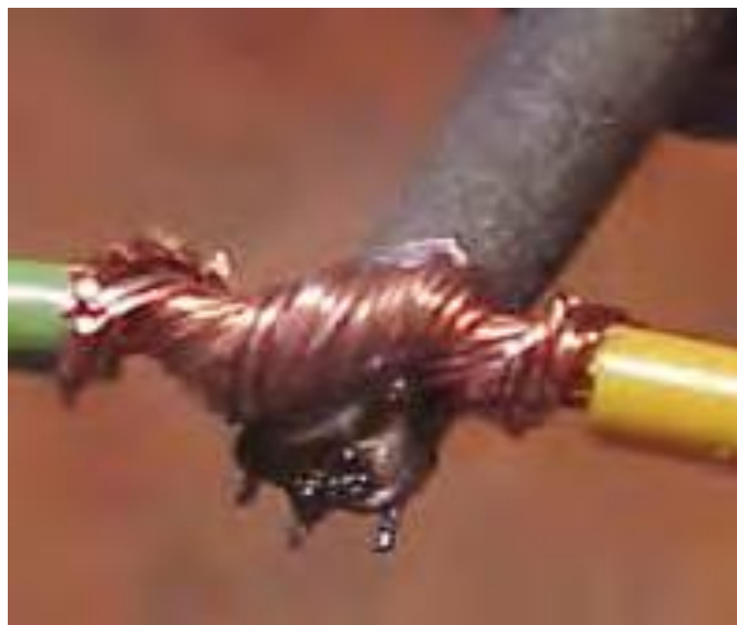
شکل ۴۹-۱ لحیم یک اتصال با سیم افشان
