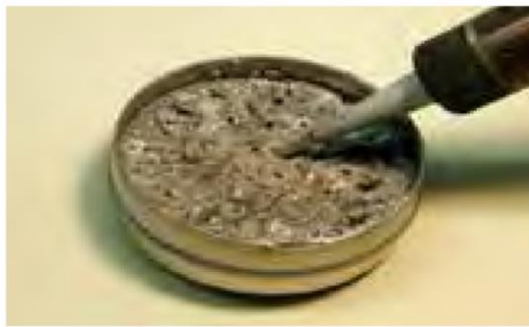
شکل ۴۱-۱ فروردن نوک هویه در روغن لحیم
