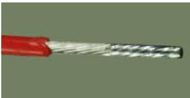
فقط قسمت بالای سیم به طور صحیح قلع اندود شده است
