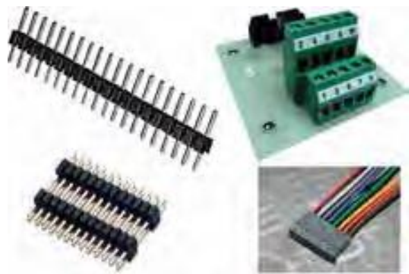
شکل ۱-۷۵ انواع پین هدر و سوکت مادگی آن
