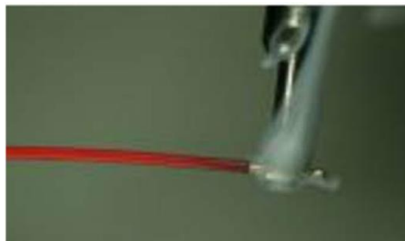
جاری شدن نفوذ لحیم روی سیم مسی
