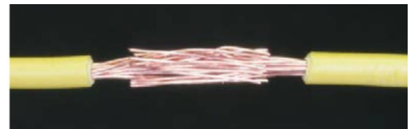
تارها را در هم بتنید و مجموعه اتصال را صاف و هماهنگ کنید
