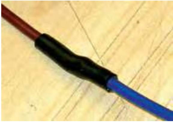
شکل ۶۲-۱ اتصال لحیم کاری شده با روکش وارنیش حرارتی ۷-
