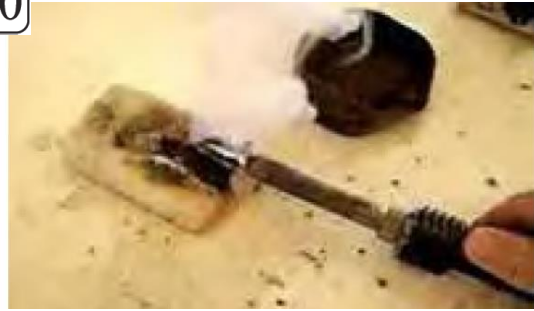
شکل ۴۲- تمیز کردن نوک هویه با اسفنج مخصوص
