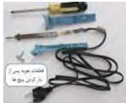
شکل ۹۴-۱ چگونگی باز کردن هویه قلمی و اجزاء آن
