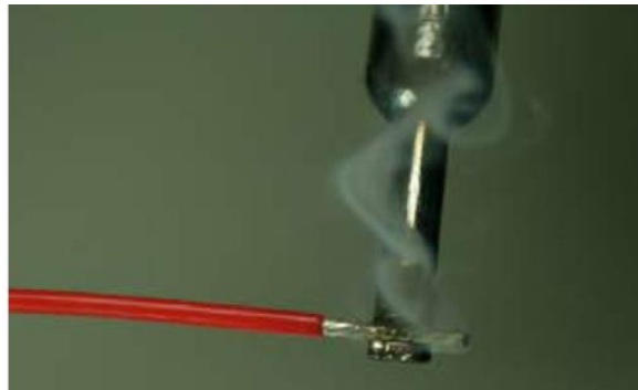
تماس نوک هویه با سیم مسی و شروع به گرم شدن
