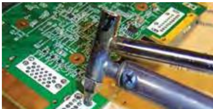
شکل ۸۷-۱ استفاده از قلع کش حرارتی
