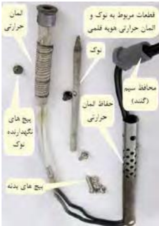
شکل ۹۵-۱ مرقت از اجزاء داخلی هویه قلمی
