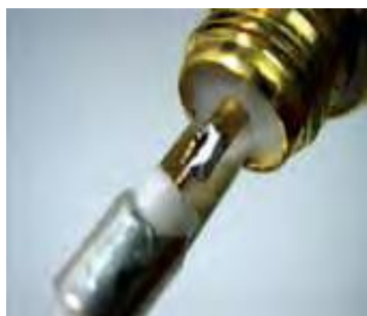
شکل ۱-۷۰ اتصال کابل کوآکسیال به فیش آنتن
