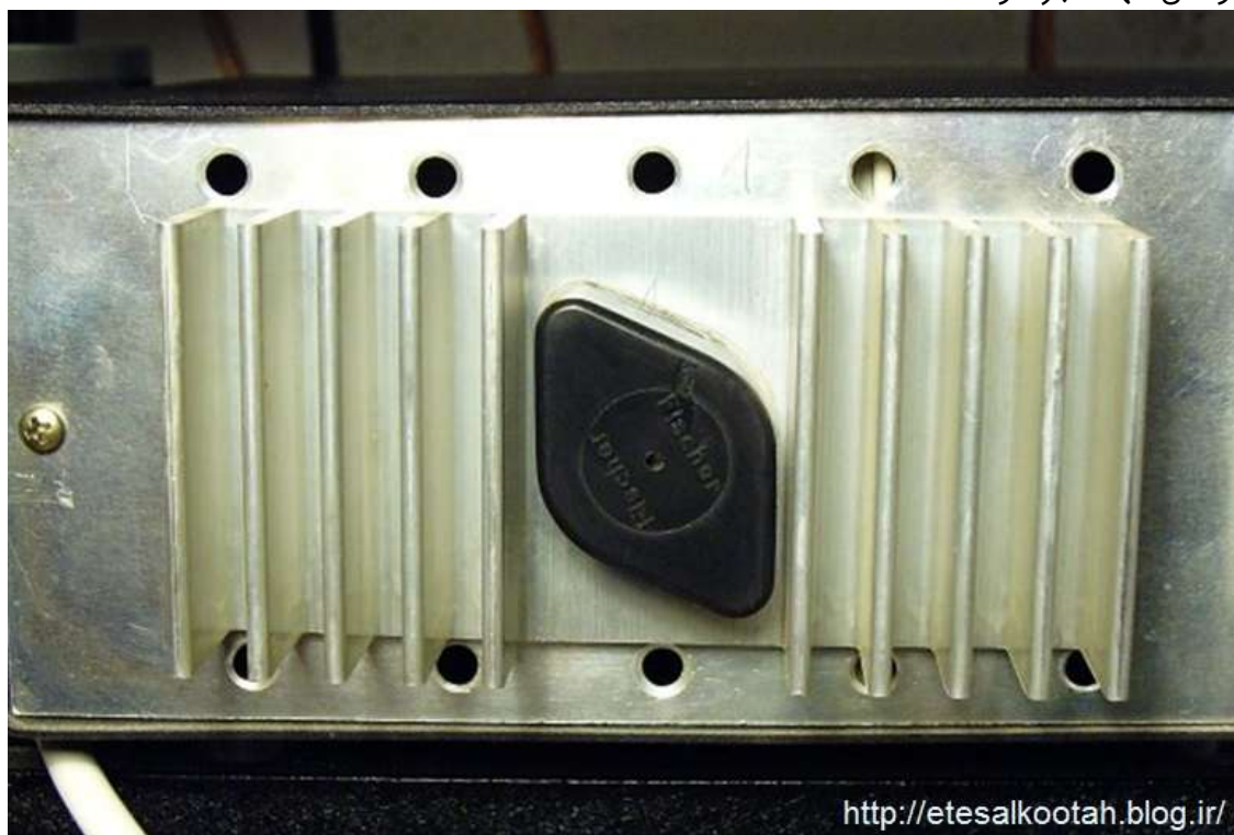
این تصویر گرماگیر ترانزیستور 2N3055 را نشان می دهد
