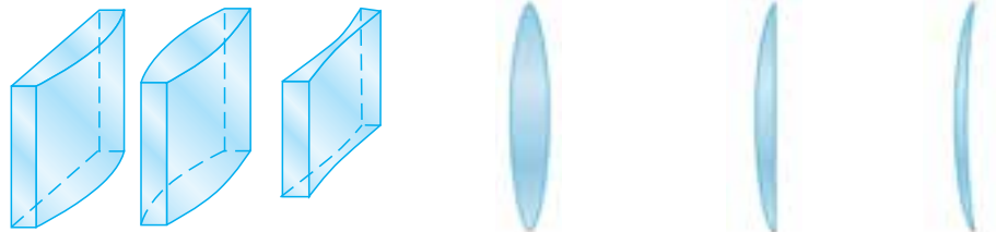
الف) دو کوز کروی (ب) کوز تخت کروی (پ) هلالی همگرای کروی (ت) عدسی‌های همگرای استوانه‌ای
