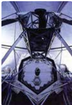
شکل ۵-۴- تلسکوپ کیک در هاوایی. در این تلسکوپ از بازتاب نور توسط تعدادی آینه مقعر استفاده می‌شود.
