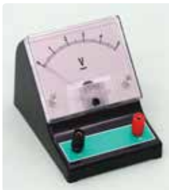
شکل ۳-۱۴- با ولتسنج اختلاف پتانسیل دو سر مولد، یا دو نقطه از مدار را اندازه می گیریم.
