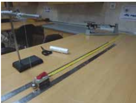
شکل ۱-۱۱- برای سادگی می‌توانید به جای ریل پرده از خط‌کش‌هایی در طرفین جعبه چوبی استفاده کنید.
