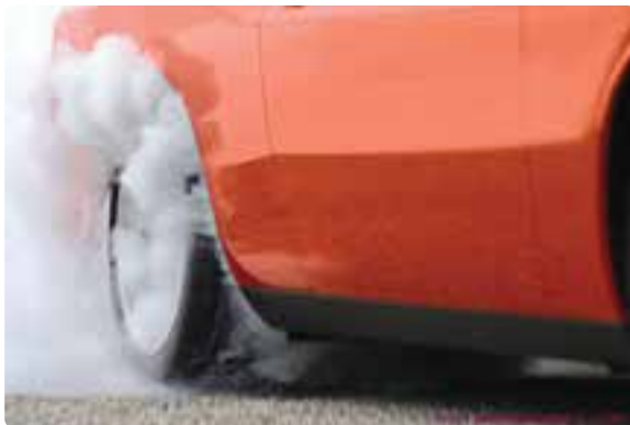
شکل ۱-۱- با گرفتن ترمز، لاستیک های خودرو و سطح جاده گرم تر می شود و بر انرژی درونی آنها افزوده می شود.
