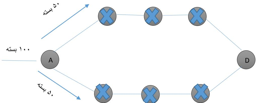
شکل بالا دارای یک طراحی خوب است و بسته ها بطور مساوی از هر دو جهت عبور می کنند ولی در شکل زیر از طراحی مناسب برخوردار نیست چون در یک طرف حلقه ایجاد شده و همیشه در گره انتهايی ترافيك وجود دارد.
