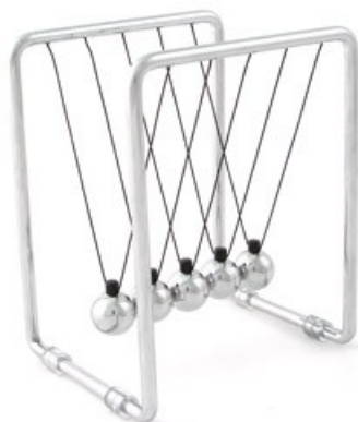
گهواره نیوتن برای نشان دادن سنت پایستگی تکانه
