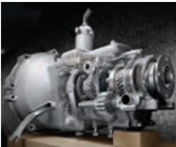
شکل ۱۵ - ترکیب پیچیده‌ای از چرخ‌دنده در جعبه‌دنده خودرو
