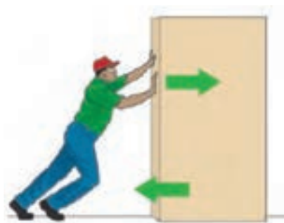
شکل ۲- شخص به جعبه ساکن نیرو وارد می‌کند ولی جعبه حرکت نمی‌کند زیرا نیروی روبه جلو با نیروی اصطکاک رو به عقب هم‌اندازه‌اند.
