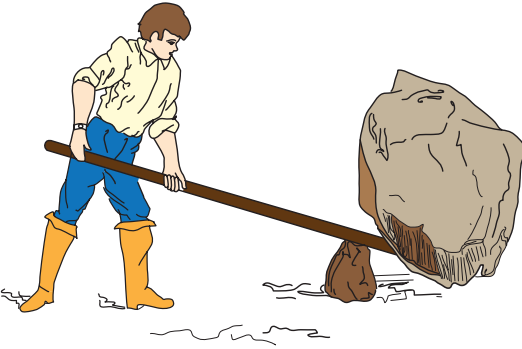
شکل ۴ - مرد با وارد کردن نیروی کوچکی بر دسته اهرم می‌تواند جسم سنگینی را بلند کند.
