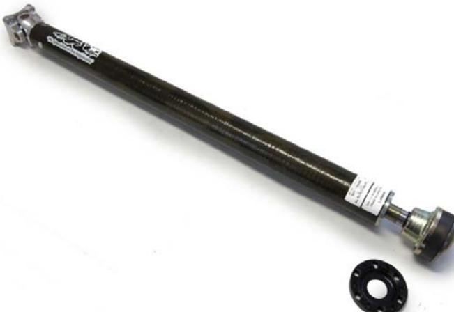
استفاده از درايو شفت های کامپوزیتی فایبر کربن به استثنای هزینه بالا، مزایای فراوانی دارد که به صورت کلی شامل موارد ذیل می باشد:
