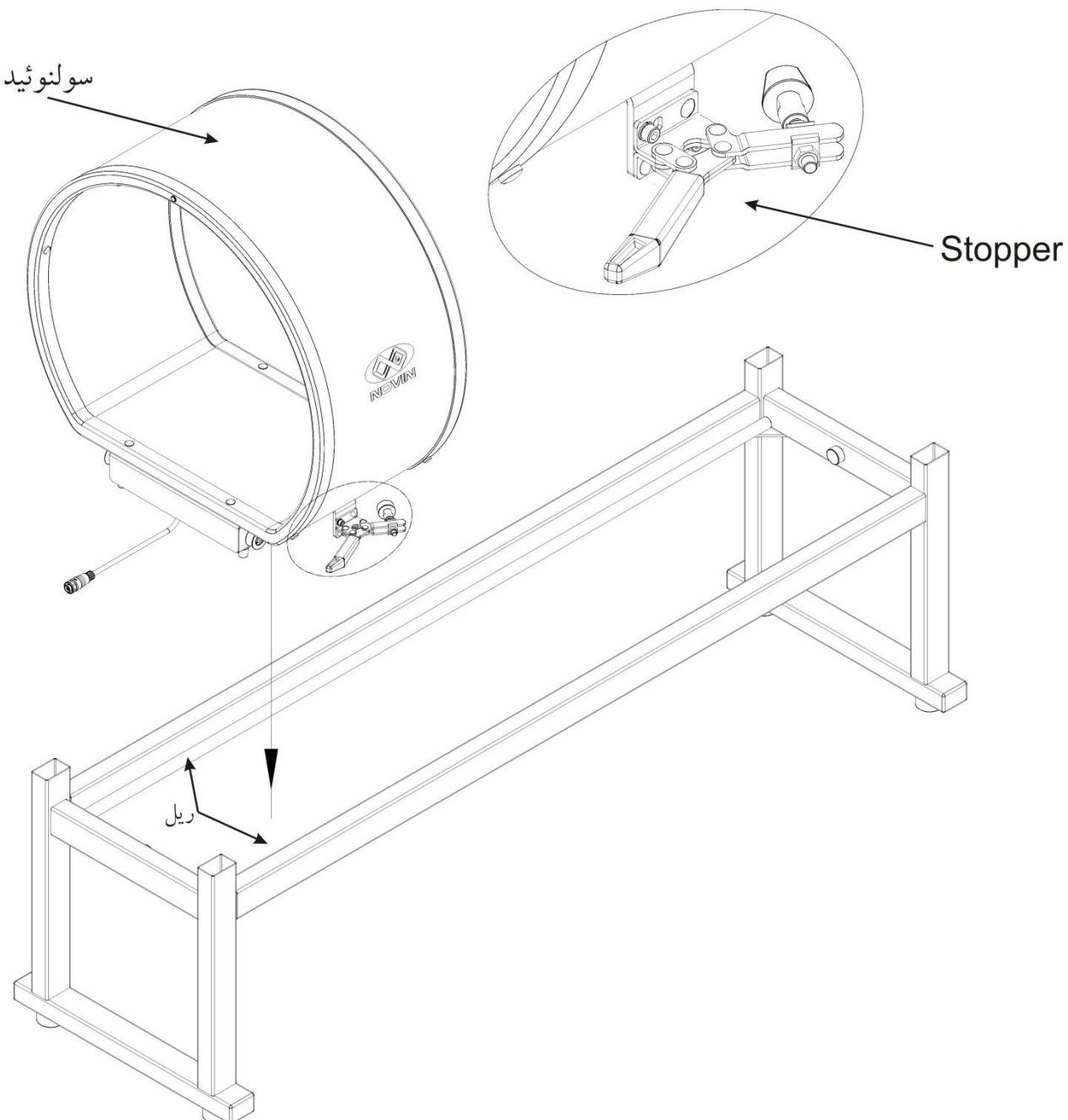
۴- بعد از قرار دادن سولنوئید در محل خود ، Stopper را در وضعیت قفل قرار دهید تا سولنوئید در جای خود ثابت شود. سپس تشك تخت را با احتیاط از داخل سولنوئید عبور داده و در محل مورد نظر قرار دهید.(بهتر است این کار توسط دو نفر انجام شود).
