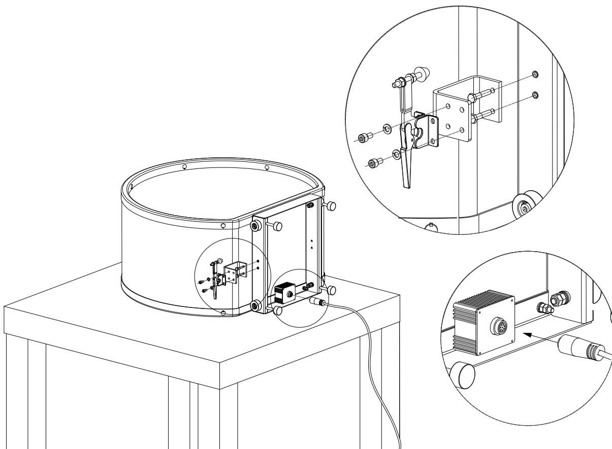
توجه: در صورت نیاز به تغییر موقعیت مجموعه ترمز، فقط کافی است دو عدد پیچ سر شش گوش، باز شده و مجموعه ترمز در سمت دیگر بدنه کریر با در نظر گرفتن موقعیت تخت بسته شود.
