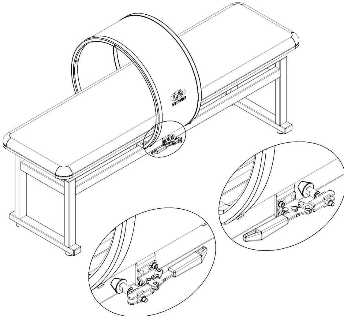
نکته ۳: میتوانید برای تنظیم میزان محکم بودن Stopper از آچار استفاده نمایید. (ابزار مورد نیاز داخل متعلقات قرار داده شده است).
