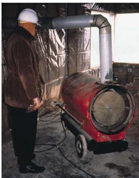
شکل ۳ بخاری غیرمستقیم یا هواکش دار، به لوله هواکش حامل گازهای اشتعال به بیرون فضای محصور توجه نمایید.
