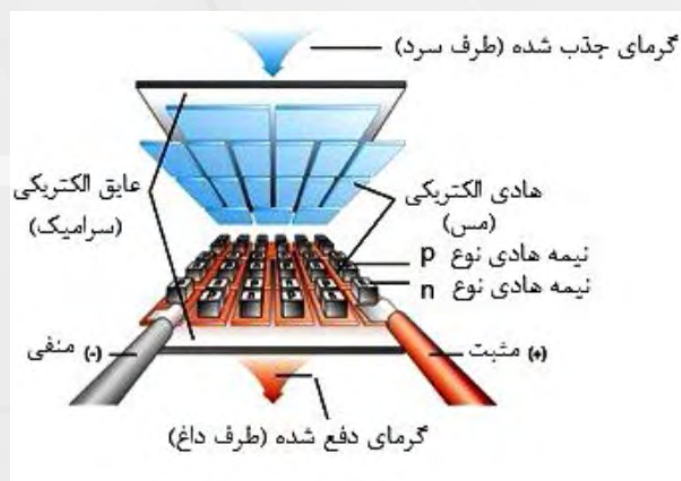
شکل ۲- خنک‌کننده ترموالکتریک یا المان پلنیر
