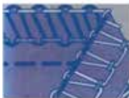
ب- اورلوک ۵ نخ پاکدوزی همراه با دوخت ساده چرخ اورلوک «اضافه درز چیده می شود»
