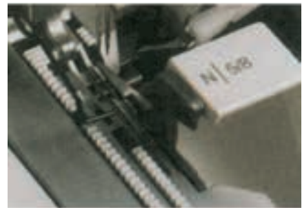
اورلوک ۲ سوزن دارد
