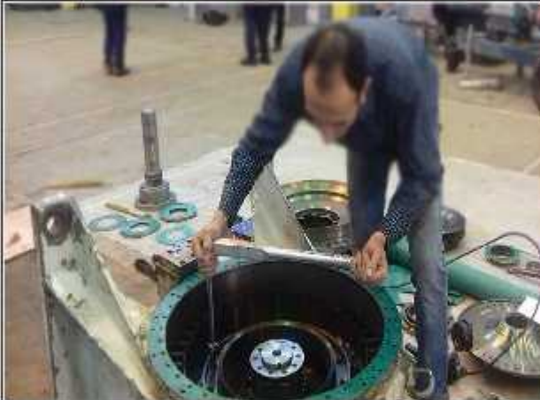
مونتاژ Torque converter
