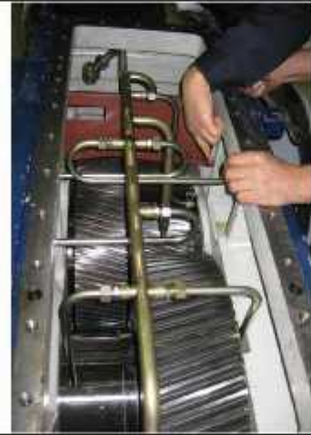
بازسازی گیربکس Flender توربین بادی 660 KW ساخت شرکت Vestas به سفارش نیروگاه بادی بینالود
