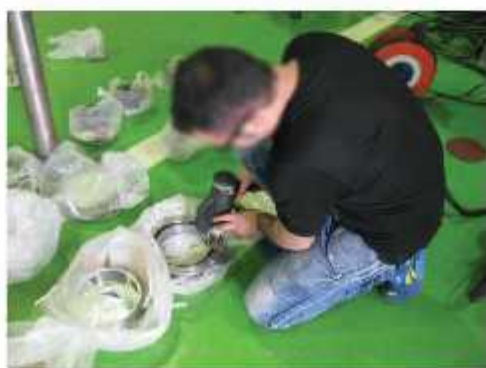
کواتومتری پرتابل در محل پروژه
