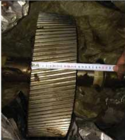
بازسازی گیربکس Flender توربین بادی 660 KW ساخت شرکت Vestas به سفارش نیروگاه بادی بینالود
