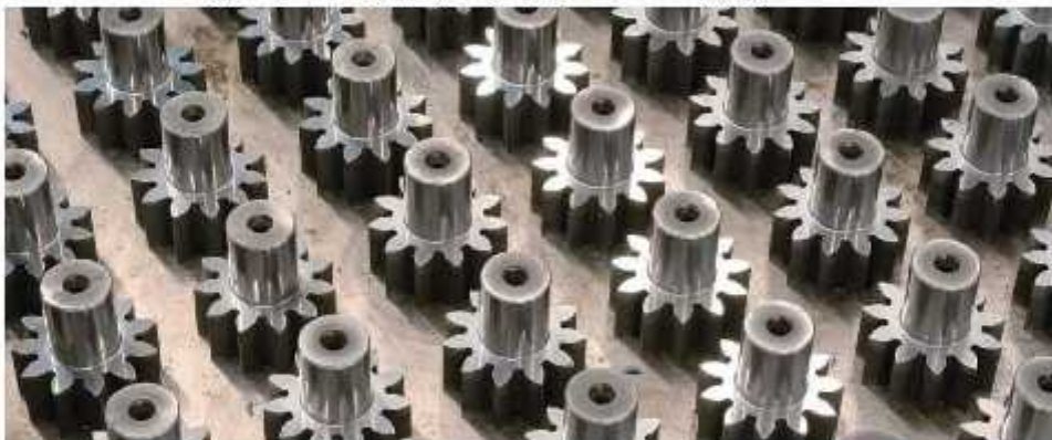
ساخت چرخ دنده های Flow Divider توربین گازی GE-P9 ساخت شرکت Scherzinger به سفارش نیروگاه آبدان
