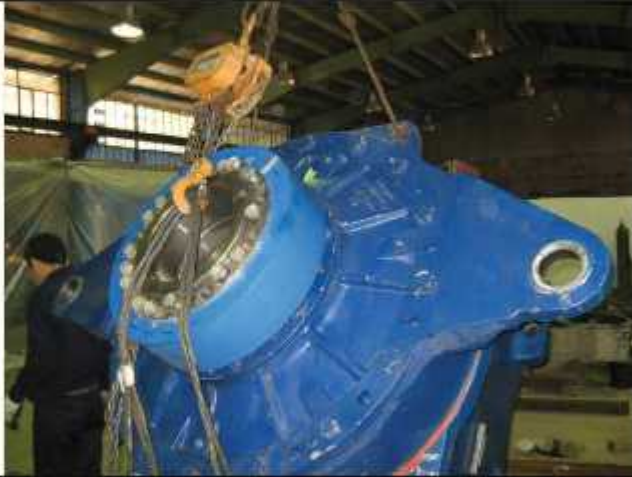
بازسازی گیربکس Flender توربین بادی 660 KW ساخت شرکت Vestas به سفارش نیروگاه بادی بینالود
