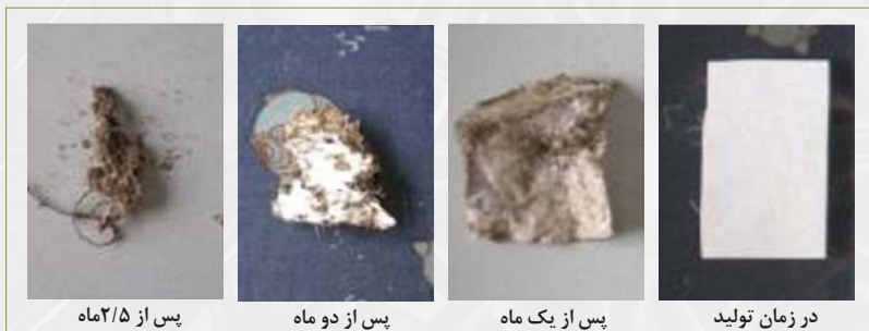
» شکل ۷. روند تخریب نانوالیاف هسته-پوسته زیست حاوی کود
