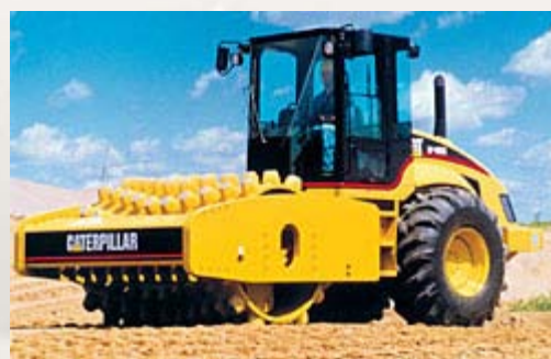
شکل ۵۲: استفاده از غلتک های پاچه بزی در آخرین مرحله تراکم هر لایه هسته رسی
