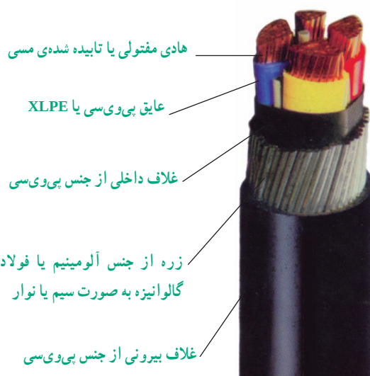
شکل ۲-۴- کابل با عایق پی‌وی‌سی به همراه اجزای کابل
