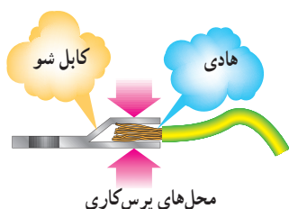
شکل ۱۸-۲- ترتیب پرس شدن کابل شو
