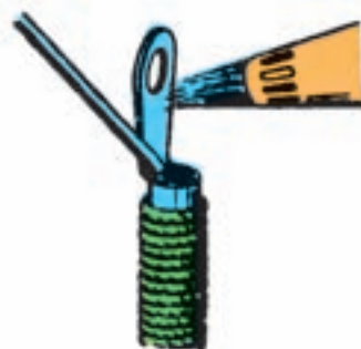
شکل ۲۲-۲- مراحل لحیم کاری کابل شو
