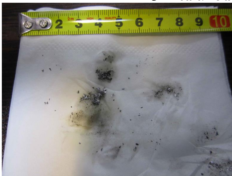
شکل ۵) وجود براده در روغن کمپرسور
