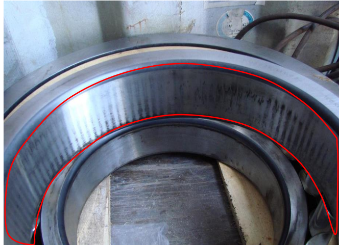
شکل ۱۰) وضعیت خرابی اجزای بیرینگ شماره دو
