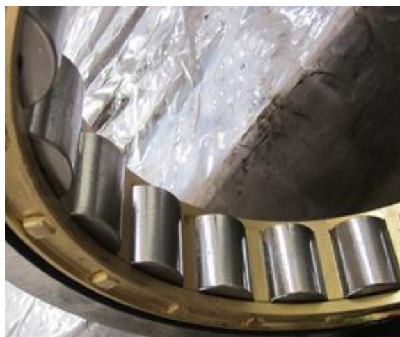
شکل ۸) وضعیت خرابی اجزای بیرینگ شماره یک
