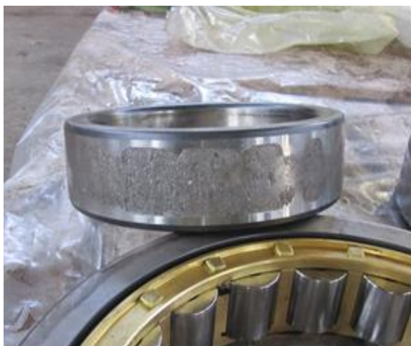
شکل ۸) وضعیت خرابی اجزای بیرینگ شماره یک
