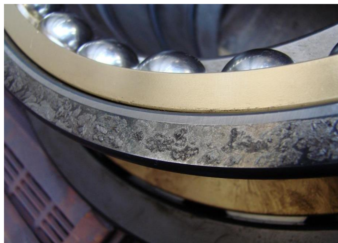
شکل ۱۲) وضعیت خرابی اجزای بیرینگ شماره چهار
