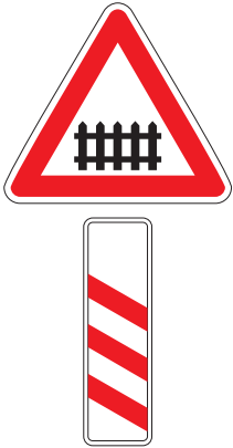
تقاطع جاده و راه آهن با راهبند نصب در ۳۰۰ متری
