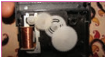
ب- بعد از باز کردن موتور ساعت
