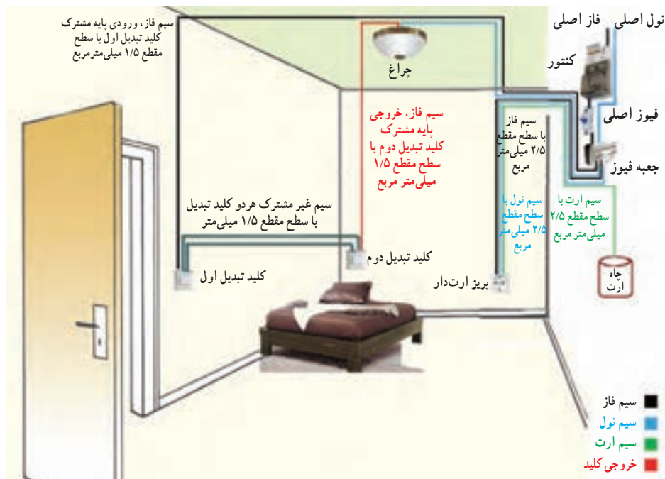
شکل ۱۸-۵ - سیم‌کشی مدار کلید تبدیل
