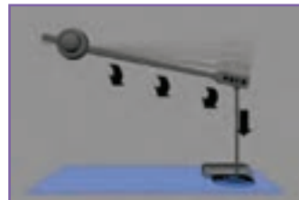
ج - برگشت خودکار درپوش پس از تخلیه آب
