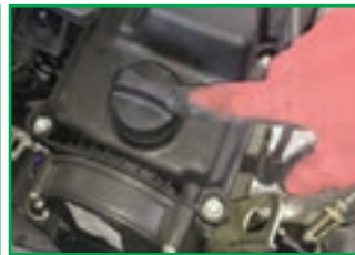
د - میله اندازه‌گیر روغن موتور را مجدداً ج - در صورت کم بودن روغن موتور، ج - به مقدار مورد نیاز، روغن به موتور بیرون کشیده و با توجه به شاخص روی درپوش مخزن روغن موتور را باز کنید. اضافه کنید. میله، مقدار روغن موتور را کنترل کنید.
