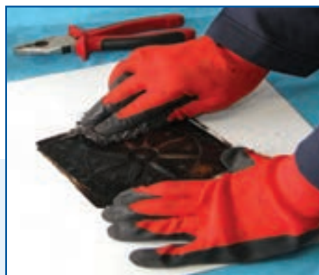
شکل ۱۳-۱۰- ساب زدن سطح پلاک مسی
