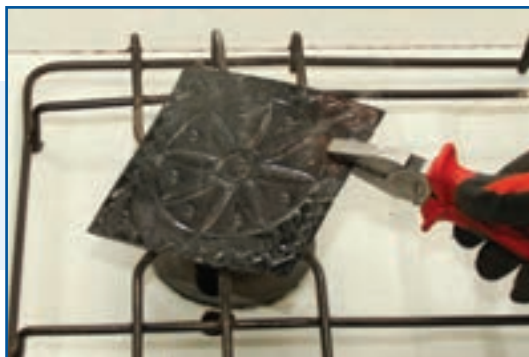
شکل ۱۱-۱۰- حرارت دادن پلاک مسی آغشته به قیر
