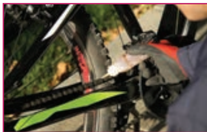
پ- روغن کاری اجزاء
