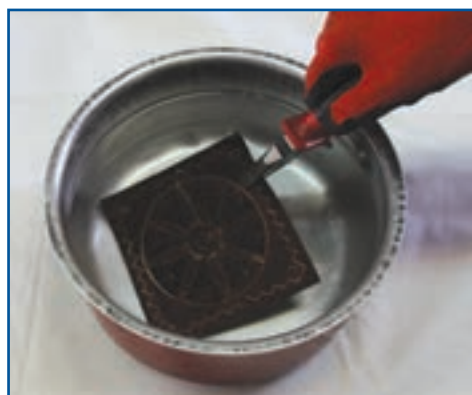
شکل ۱۲-۱۰- سرد کردن پلاک مسی آغشته به قیر با آب
