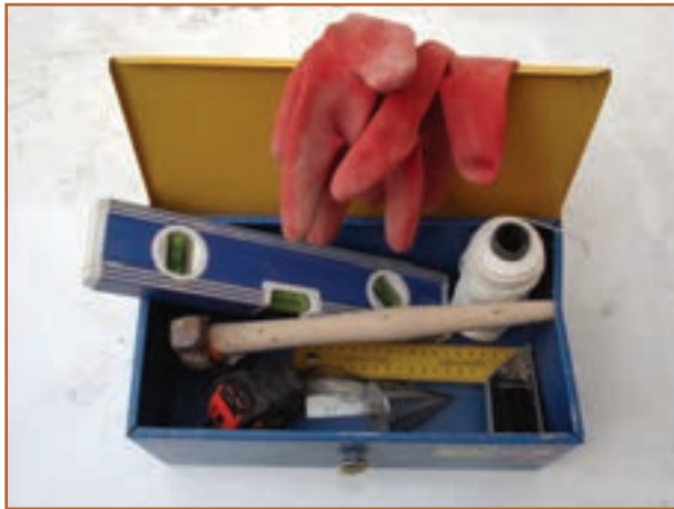
شکل ۱۰-۷- برخی از ابزار مورد نیاز دیوار چینی
