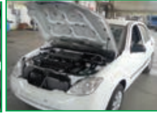
پ - میله اندازه‌گیر روغن موتور را بیرون بکشید.
