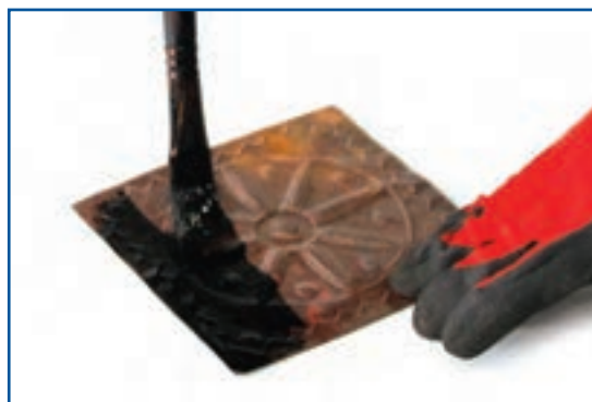
شکل ۱۰-۱- آغشته کردن سطح پلاک مسی به قیر
