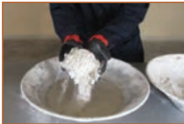
ب - اضافه کردن گچ به آب
