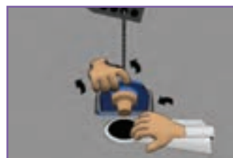
د - تمیز کردن زیر درپوش (پس از بستن شیر ورودی)
