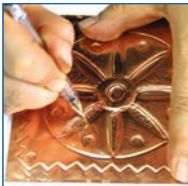
شکل ۶-۱۰- نحوه اجرای بافت
