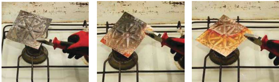
شکل ۸-۱۰- حرارت دادن پلاک مسی با گاز
