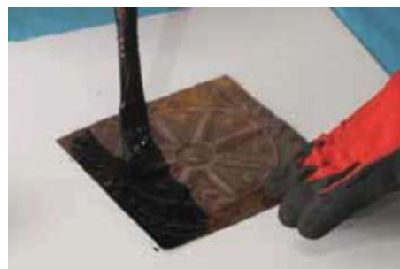
شکل ۱۰-۱۰- آغشته کردن سطح پلاک مسی به قیر
