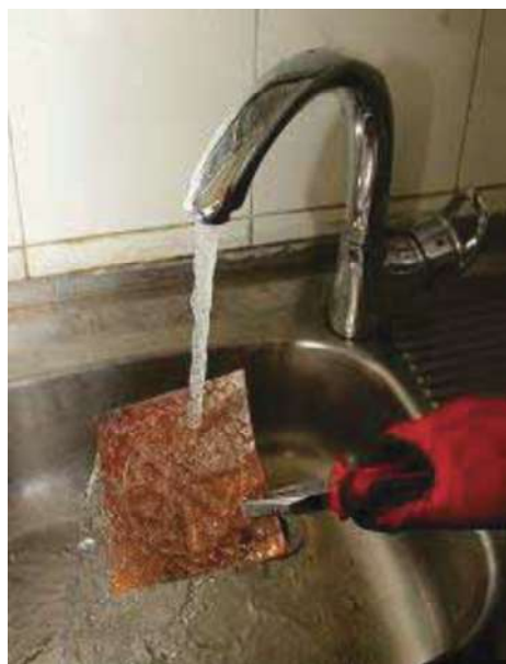
شکل ۹-۱۰- سرد کردن پلاک مسی با آب
