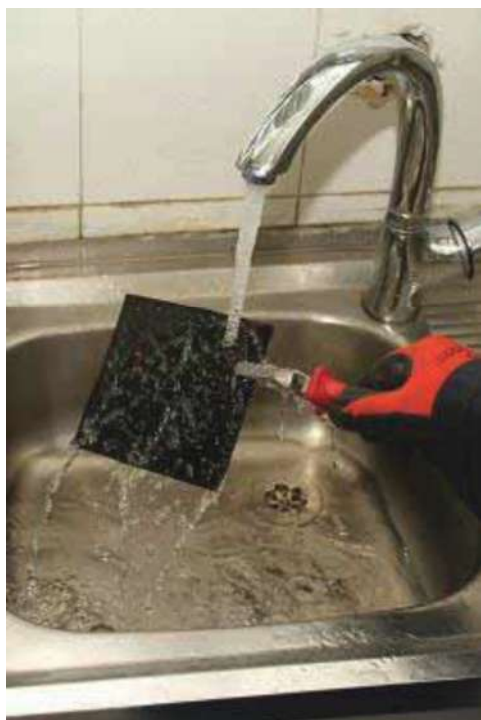
شکل ۱۲-۱۰- سرد کردن پلاک مسی آغشته به قیر با آب
