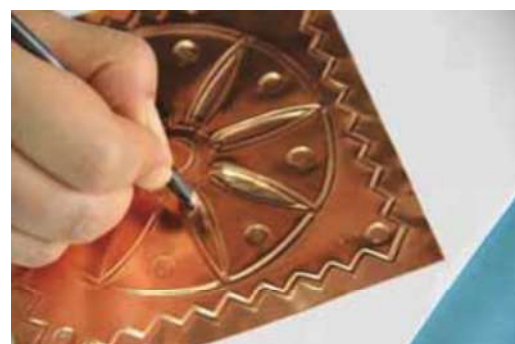
پ- گود کردن سطح از پشت
