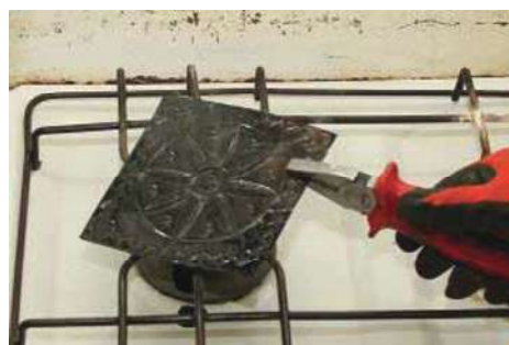
شکل ۱۱-۱۰- حرارت دادن پلاک مسی آغشته به قیر
