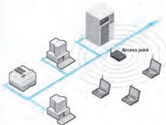
شکل (۲-۴) شبکه بی سیم (Wi-Fi) متصل به شبکه محلی
