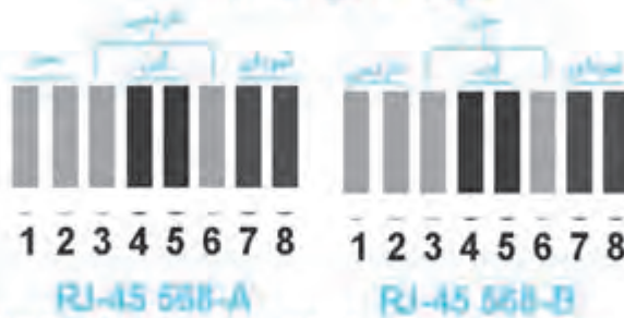
شکل (۳-۱۶) سرپیچ پینهای RJ-45 براساس استاندارد 568A و 568B
