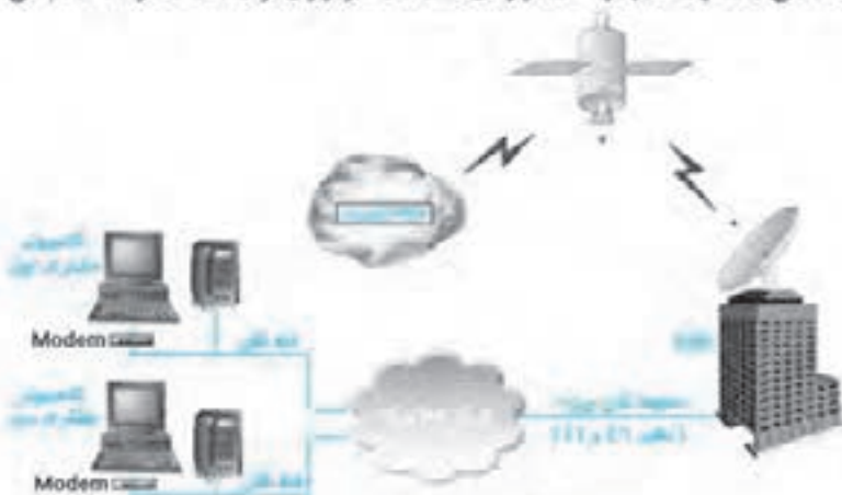
شکل ۱۲-۱۲: نحوه عملکرد و استفاده از ISP
