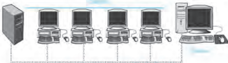
شکل ۲-۵ شبکه مبتنی بر سرویس دهنده
