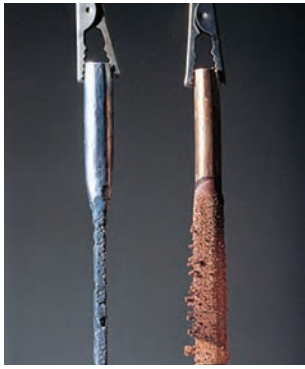
شکل ۸ - تغییر جرم تیغه‌ها پس از کار کردن در سلول گالوانی روی - مس.
