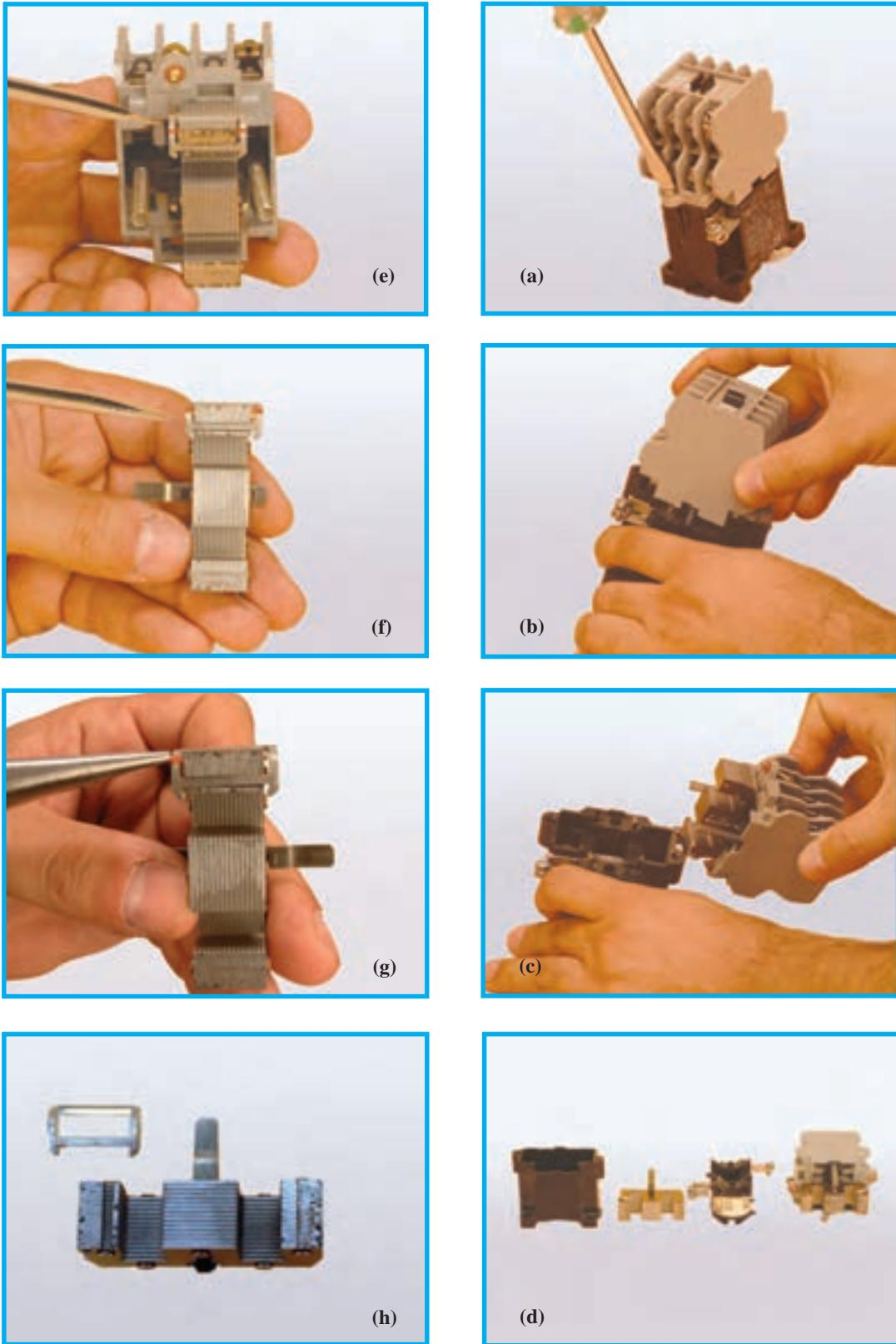
شکل ۴-۳- مراحل باز کردن اجزای تشکیل دهنده کنتاکتور
