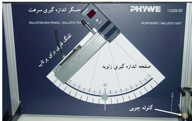
شکل ۳- بخش پرتاب، اندازه‌گیری سرعت و تنظیم زاویه
