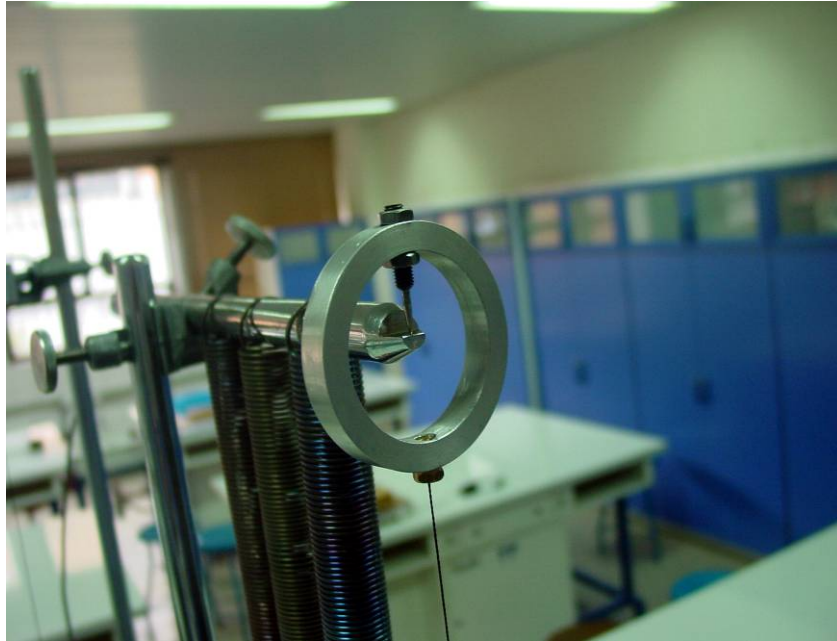
شکل ۲- نحوه قرار گرفتن سوزن حلقه روی تکیه‌گاه
