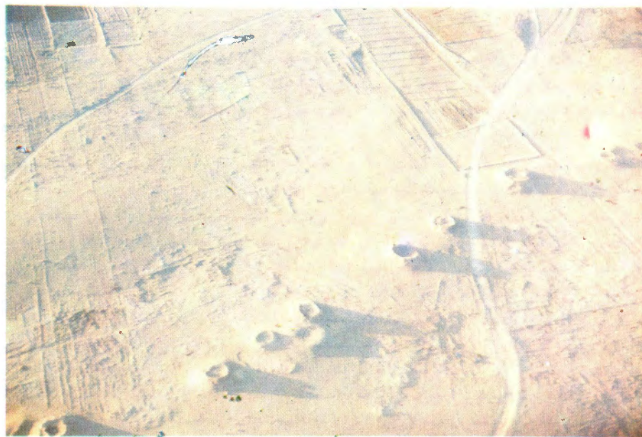
شکل ۶۵ - توده های خاک که اطراف چاه انباشته میشوند هنگام پرواز با هواپیما بر روی زمین روستاها . منظره ای خاص به مسیر قناتها میدهند و جهت آنها بر روی زمین کاملاً مشخص و قابل رویت می‌سازند .
