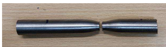
شکل ۱۲ تست کشش نمونه A
