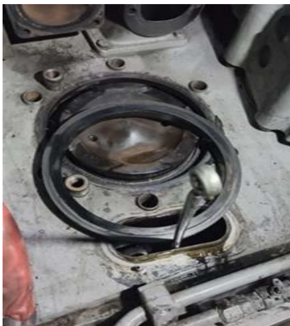
شکل ۵ فلنج شکسته لایندر B
