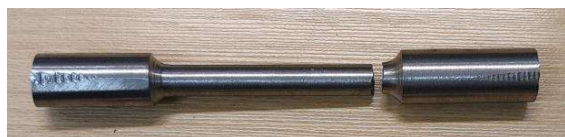
شکل ۱۳ تست کشش نمونه B
