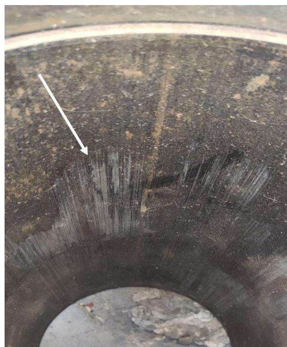
شکل ۷ خط و خش لاینر C
