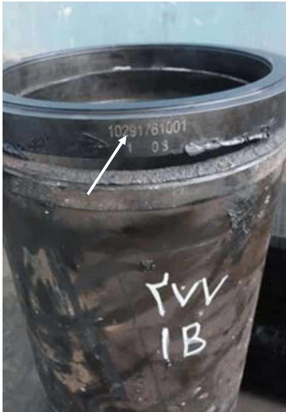
شکل ۴ شکستن لایندر B از محل فلنج
