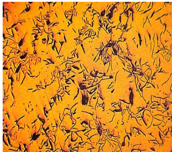
شکل ۱۷ لایتر B بزرگنمایی ۱۰۰X-گرافیت های ورقه ای
