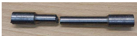
شکل ۱۴ تست کشش نمونه C
