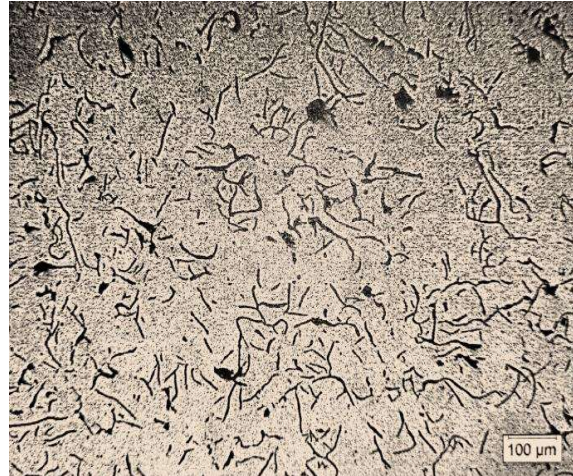
شکل ۱۶ لایتر A بزرگنمایی ۱۰۰X-گرافیت های ورقه ای
