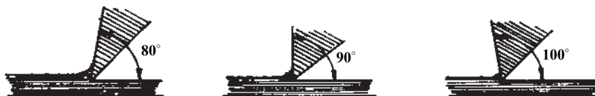
شکل ۱-۱۰- هر قدر زاویه‌ی برش کم‌تر باشد، تیغه براده بیش‌تری برمی‌دارد.
