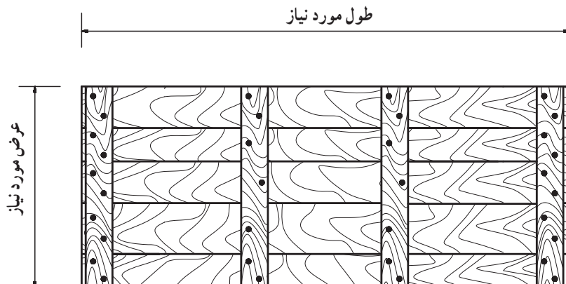
شکل ۱-۱۰۰- پس از نصب پشت‌بندها، تنگ‌ها باز می‌شوند و خطوط عرضی بریده می‌شوند.
