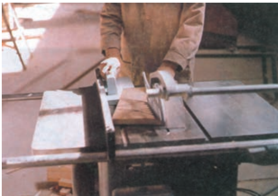
شکل ۶۹-۱ برش مورب تخته با استفاده از قالب هدایت چوبی آسان‌تر و بی‌خطرتر است.
