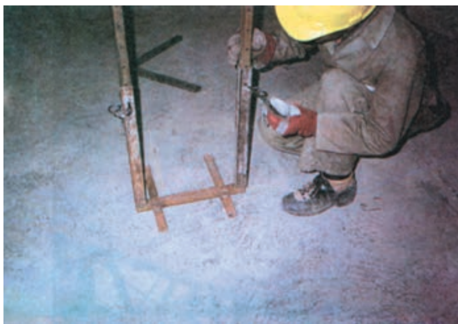
شکل ۹۵-۲- خرک قابل تنظیم برای ارتفاع های متفاوت
